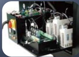
Servo Motor Controller Module
